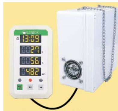
「あぐりログBOX」外観 表示BOX（左）には現在時刻・温度・湿度・二酸化炭素濃度が表示される
