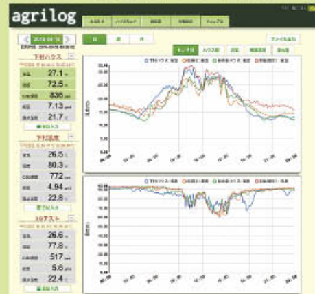
『あぐりログBOX』のデータ表示画面 温度・湿度・二酸化炭素濃度の変化のグラフを他の利用者と比較することができ、情報交換に役立つ
